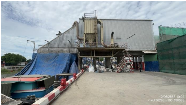
โกรกลสินค้า A และเครื่องดักฝุ่นแบบถุงกรอง (Bag Filter)
